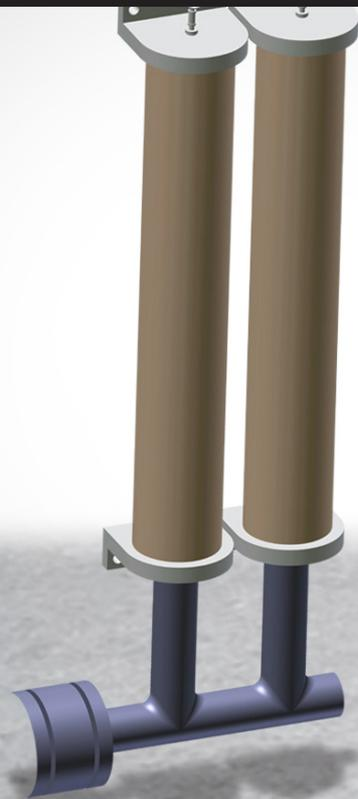
El cilindro de balance dual duplica la cantidad de fluido hidráulico presente en el sistema de posicionamiento del eje principal.
