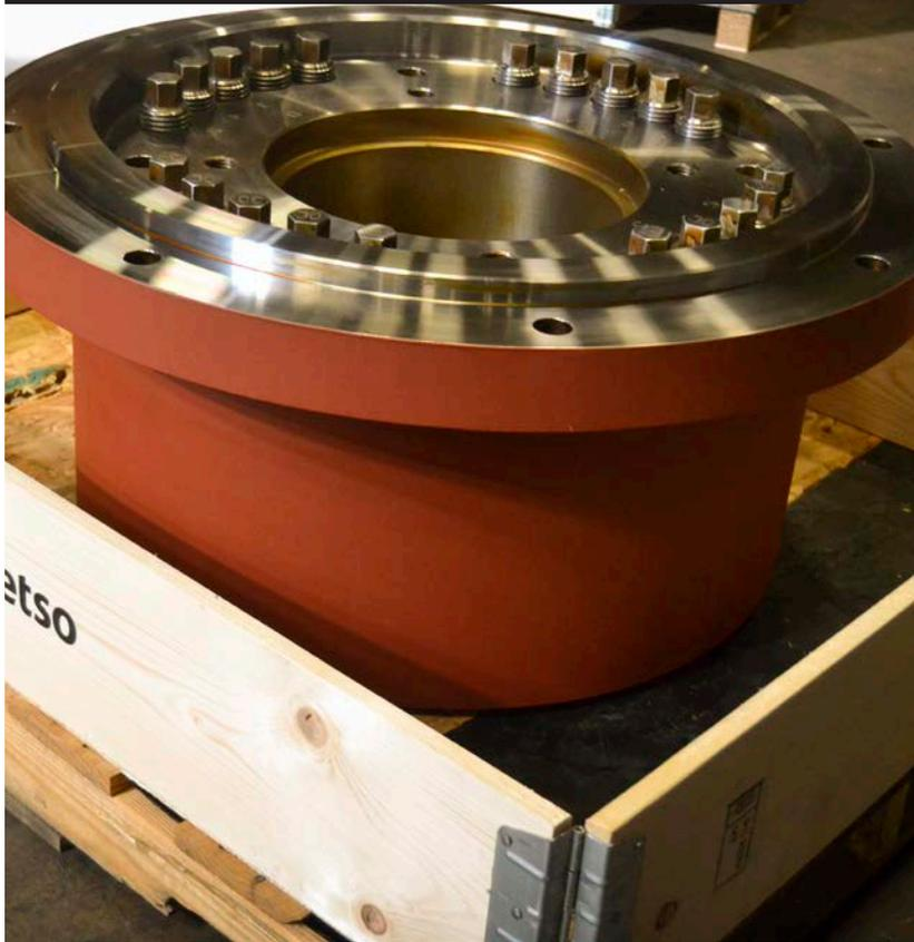
Cuidadosamente diseñada y pensada en función del mantenimiento; la tuerca de bloqueo con tornillos gato (jackscrews) simplifica la tarea de reemplazar el manto de tu chancador.
